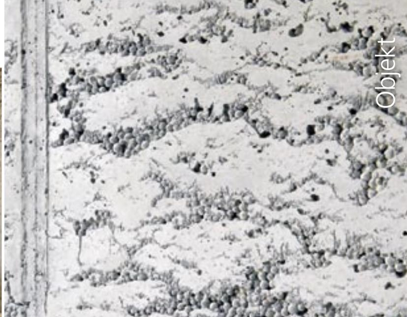
*Die Struktur zeigt, was in diesem Liapor-Isolationsbeton steckt: hochwertiger Blähton für beste Wärmedämmung.*
