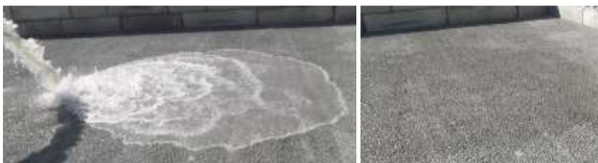
*Pervia®-Betone lassen Regenwasser in den Untergrund versickern.*
