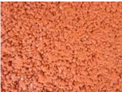
**Nahaufnahme der offenporigen Oberfläche von Pervia Classic®: Regenwasser kann durch die Schicht versickern.**
