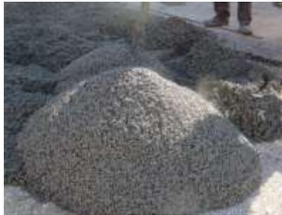
*Pervia wird in gleichbleibender Qualität im Werk produziert und mit dem Fahrmischer zum Einbauort geliefert.*
